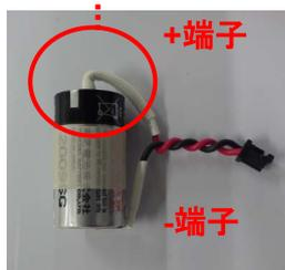
+端子からのリード線(○部)がケース奥の溝(□部)に収まる様に、+端子からのリード線を水平右向きとして、挿入してください。
