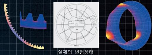
유성치차감속기는 태양치차와 유성치차, 유성치차와 내치차가 각각 동시에 물린 구조로 되어 있습니다. 이로 인해 부품의 치수정도만으로 백래쉬를 작게하면 치수오차의 영향으로 맞물리는 부분에 간섭이 일어나 회전토크가 일정하지 않거나 소음이 원인이 됩니다. 이러한 문제를 해결하기 위해 맞물리는 부분의 간섭을 완화하는 기능이나 충분한 강도를 겸비한 [박육탄성내치차]가 개발되어 획기적인 구조의 유성치차감속기인 하모닉유성치차감속기가 탄생하였습니다.
