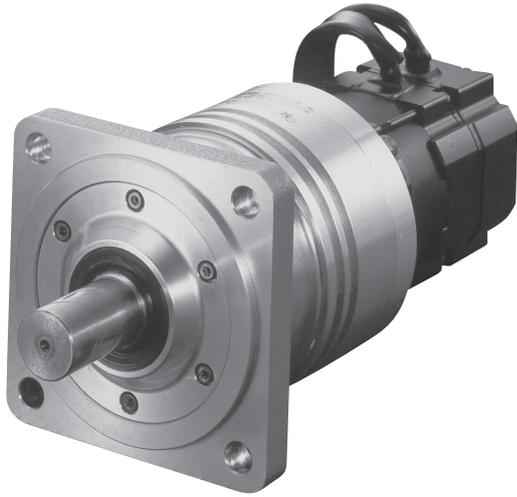
RSF 시리즈는 정밀제어용감속기 하모닉드라이브®와 AC 서보모터를 조합한 소형, 고토크, 고회전경도로 샤프트출력의 AC 서보액츄에이터입니다. 이 RSF 시리즈의 성능을 충분히 발휘하게 하는 전용서보드라이버와의 세트로 고회전경도의 컴팩트한 기계장치를 실현합니다.
