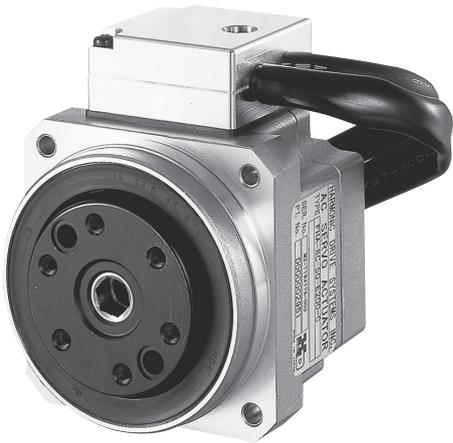
FHA-C mini 시리즈는 박형·정밀제어용감속기 하모닉드라이브®와 초편평 AC서보모터를 일체화한 AC서보액츄에이터입니다. 입력 전원전압 DC24V 사양을 새롭게 추가하였습니다.
