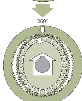
웨이브제네레이터가 1회전(360도)하면 플렉스플라인은 서클러스플라인에 비해 잇수가 2매 적기때문에 잇수차 2매분만큼 반시계방향으로 이동합니다. 일반적으로 이런 움직임으로 출력을 냅니다.
